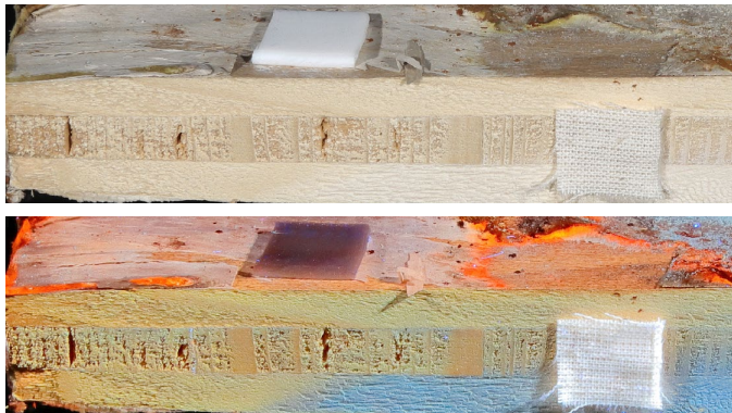
Abb. 02: Fichte-Dreischichtplatte, die vom Brautfäulepilz Serpula lacrymans befallen ist. Oben: Normalbild, unten: UV angeregtes Fluoreszenzbild. Die bereits vom Mycel durchwachsenen und teilweise abgebauten Bereiche fluoreszieren gelblich, während das unbefallene Holz (rechts unten) in tieferen Schichten grünlich-blau fluoresziert. [Foto: Dr. F.B. Peters]
