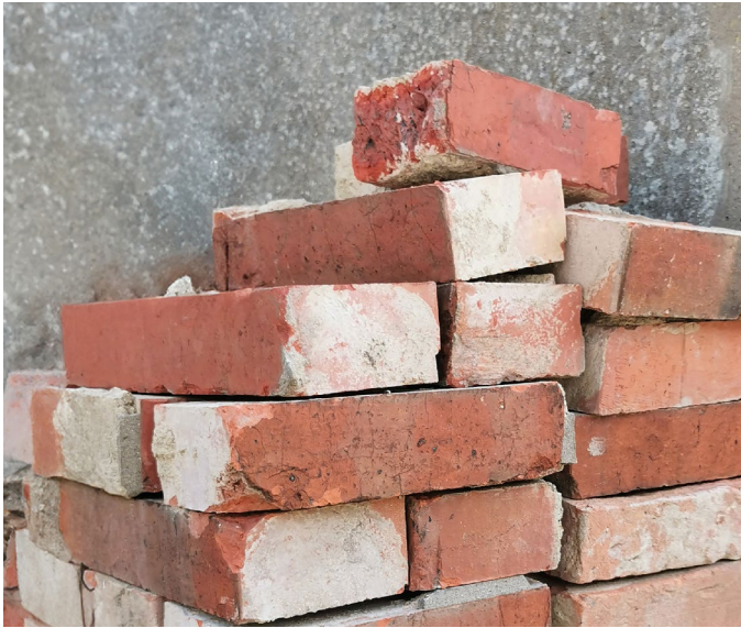
Abb. 03: Die Wiederverwendung von Ziegelsteinen ist flexibel, aber arbeitsintensiv und stark von der Qualität des Rückbaus abhängig. [Foto: Concular GmbH]
